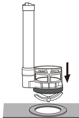
1. Ao girar o corpo da válvula de drenagem para a abertura da base, remove o corpo da válvula de drenagem para cima.
