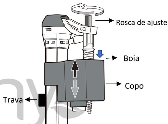
3. Após conectar a mangueira de abastecimento, ajuste o volume de água retirando a trava e girando o corpo inferior no sentido horário, fazendo o corpo subir ou descer até que se obtenha o ajuste conforme altura da caixa, gire o corpo no sentido anti-horário e reposicione a trava.
