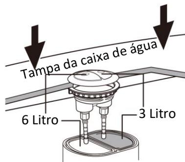
4. Posicione a tampa no tanque de água e certifique-se de que os botões de acionamento de descarga completa e descarga parcial correspondem ao indicado na válvula de drenagem.
