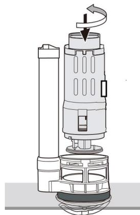
4. Com a base fixada, posicione o corpo principal da válvula de drenagem e gire-a para uma posição fixa.
