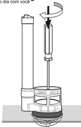
3. Use uma chave de fenda para apertar os parafusos da base de modo que fique bem fixada.
