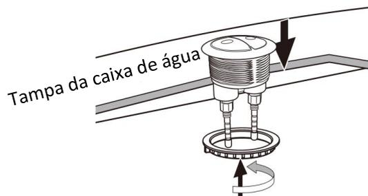
3. Coloque o corpo do botão no orifício de montagem localizado na tampa do tanque de água, aperte a porca para fixar o botão.
