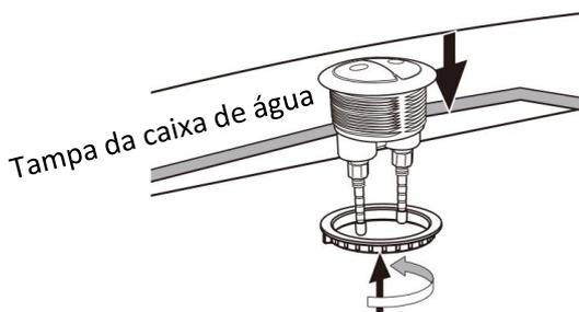
3. Coloque o corpo do botão no orifício de montagem localizado na tampa do tanque de água, aperte a porca para fixar o botão.
